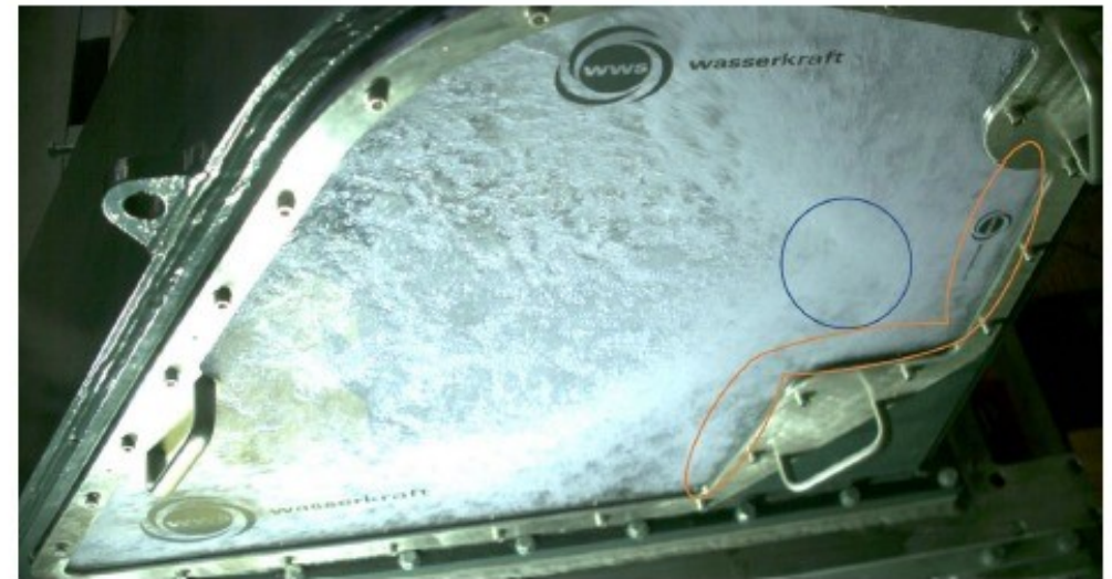
Abbildung 8-11: oben koaxiale Ansicht, unten isometrische Ansicht des Punkts besten Wirkungsgrads im zweidüsigen Betrieb
